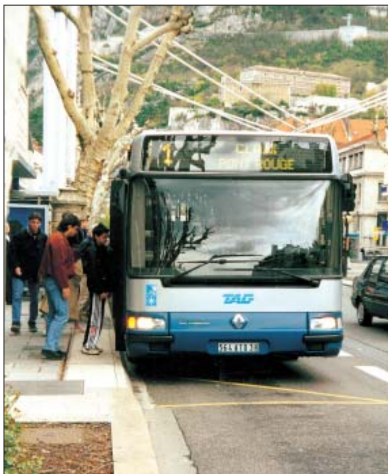
Accostage facilité par une bordure de trottoir en biais
